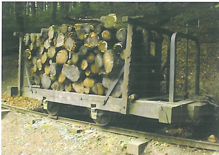
A kisvasutakon rönkszállításra használt kétfélszemes Lóré.
